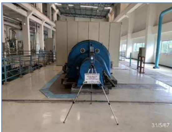
รูปที่ 3.11 การตรวจวัดระดับความร้อนในพื้นที่ทำงานบริเวณเครื่องกำเนิดไฟฟ้า
