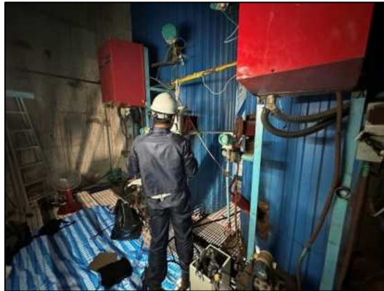
รูปที่ 3.29 การเก็บตัวอย่างคุณภาพอากาศปล่องระบาย
