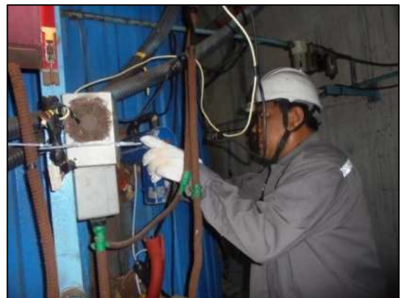
รูปที่ 3.30 การเก็บตัวอย่างคุณภาพอากาศแบบต่อเนื่อง (CEMs)
